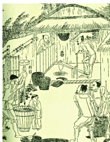
(a) 舂（采自《天工开物》） (b) 桔槔（采自《天工开物》）
